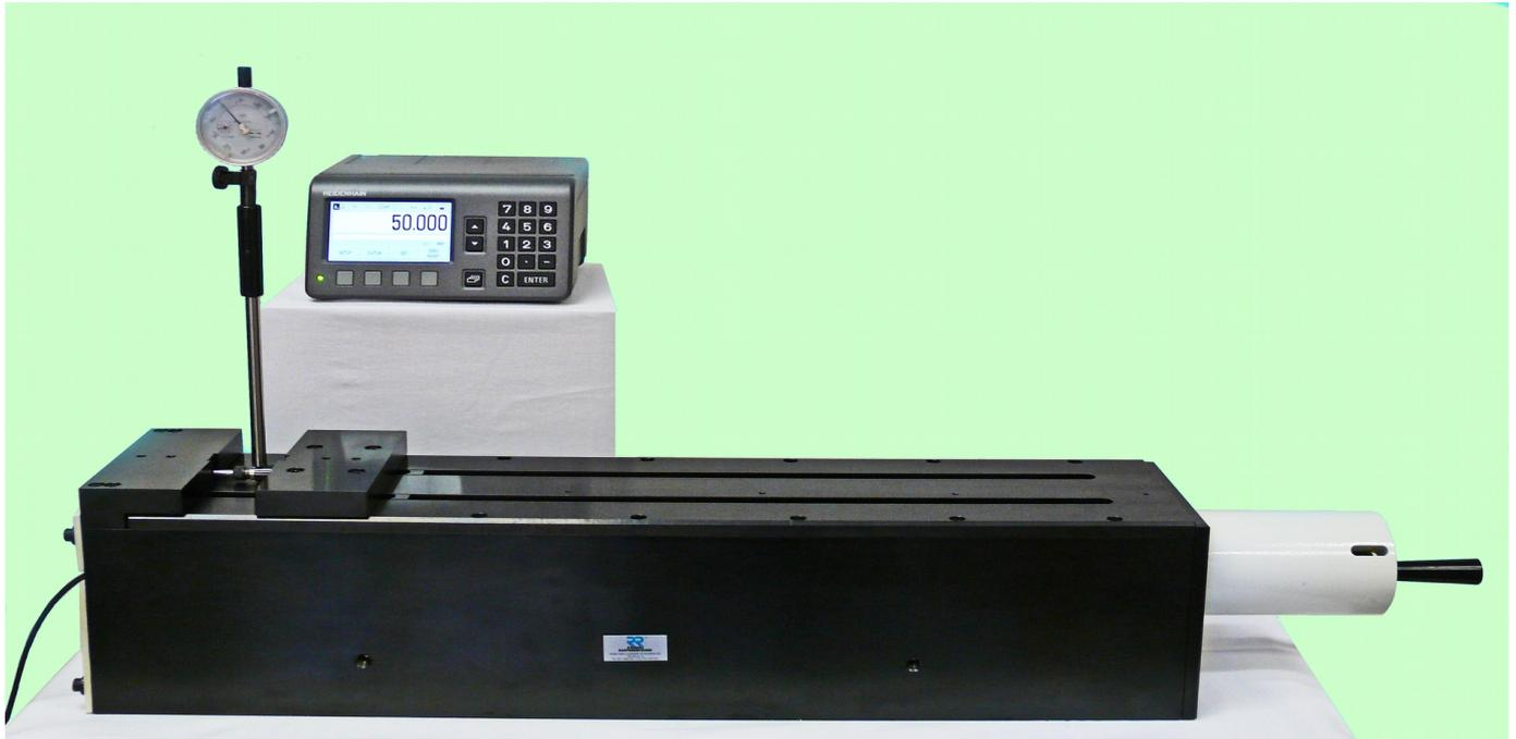
**LO STRUMENTO È STATO CONCEPITO PER L'AZZERAMENTO E IL CONTROLLO DI QUALSIASI TIPO DI ALESAMETRO COMPRESI GLI ALESAMETRI PER FORI CIECHI E I CALIBRI CON COMPARATORE.**
