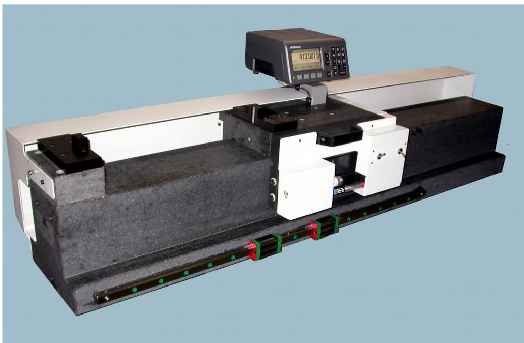
**MISURATORE LONGITUDINALE DI LUNGHEZZE PER L'AZZERAMENTO DEGLI ALESAMETRI, MICROMETRI PER ESTERNI, STRUMENTI PER GRANDI DIMENSIONI INTERNI/ESTERNI. ADATTO ANCHE PER LA TARATURA PERIODICA DEGLI STESSI.**
