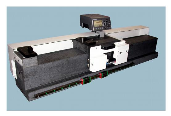
MISURATORE LONGITUDINALE DI LUNGHEZZE PER L'AZZERAMENTO DEGLI ALESAMETRI, MICROMETRI PER ESTERNI, STRUMENTI PER INTERNI/ESTERNI. ADATTO ANCHE PER LA TARATURA PERIODICA DEGLI STESSI.
