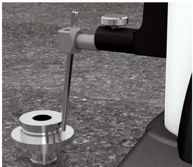
Determinazione dell'altezza di una scanalatura su un pezzo integrato in uno strumento di misura per l'endoscopia
