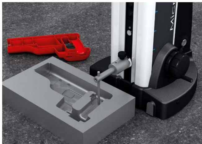
Misura di uno stampo ad iniezione per cassa in plastica di un trapano
