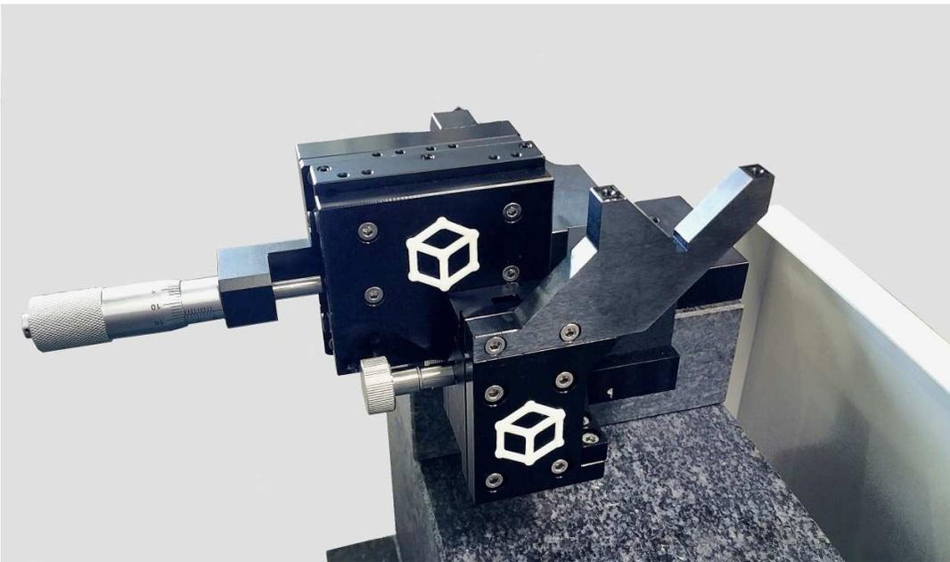
I supporti regolabili per il banco di misura ZEUS, sono realizzati con slitte di precisione a comando manuale.
